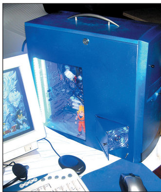
Schmuckstück ganz in blau: Die Kühlklappe (rechts unten) öffnet sich automatisch.
